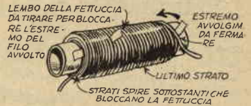
FIG.33 - COME AVVOLGERE IL FILO CONDUTTORE NUDO
