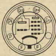
DCH 25 TRIODO-5000 ACCENSIONE 1,2 V. 0,1 A. ANODICA 90 V. + G2-G4 - 50 V. + Pt-50V. +
